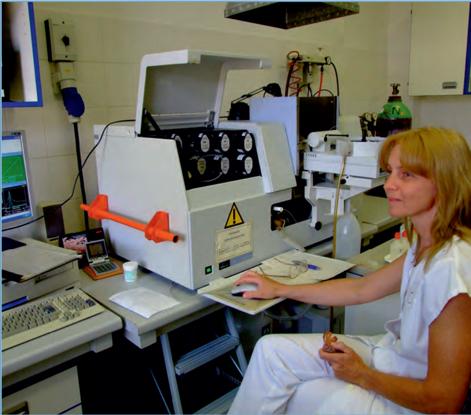
A nehézfém tartalom vizsgálata a szennyvíz laborban (Kovács Jánosné laboráns)
